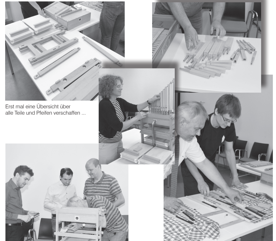
Auch wenn man ständig Tasten „unter den Fingern“ hat: Eine Tastatur aus einzelnen Tasten zusammenzubauen, ist gar nicht so leicht (rechts), und dann müssen sie auch noch einzeln eingehängt werden (links).
